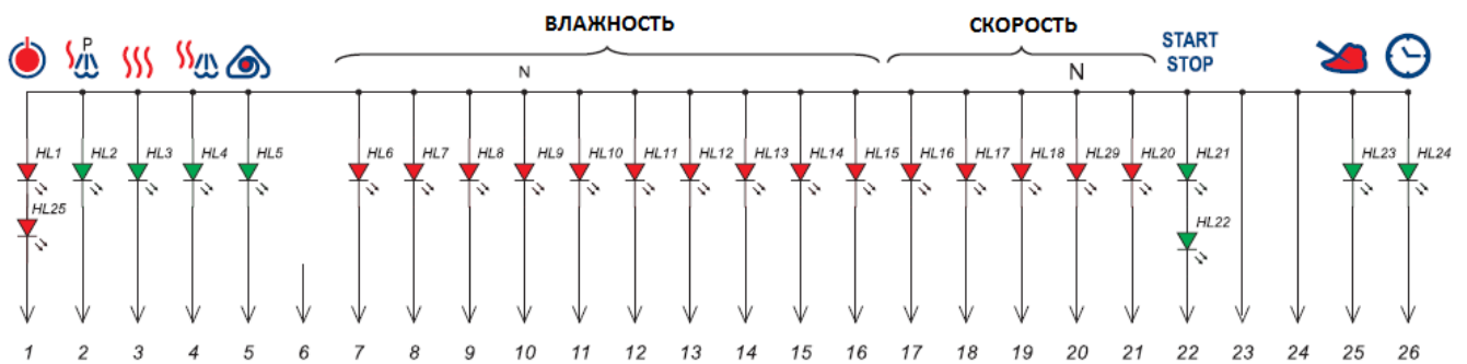
Схема электрическая соединения светодиодов
