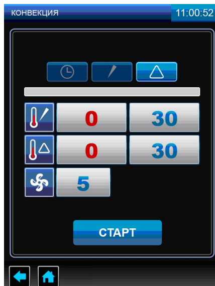
Рис.16 Режим «КОНВЕКЦИЯ» с использованием параметра «ДЕЛЬТА»
